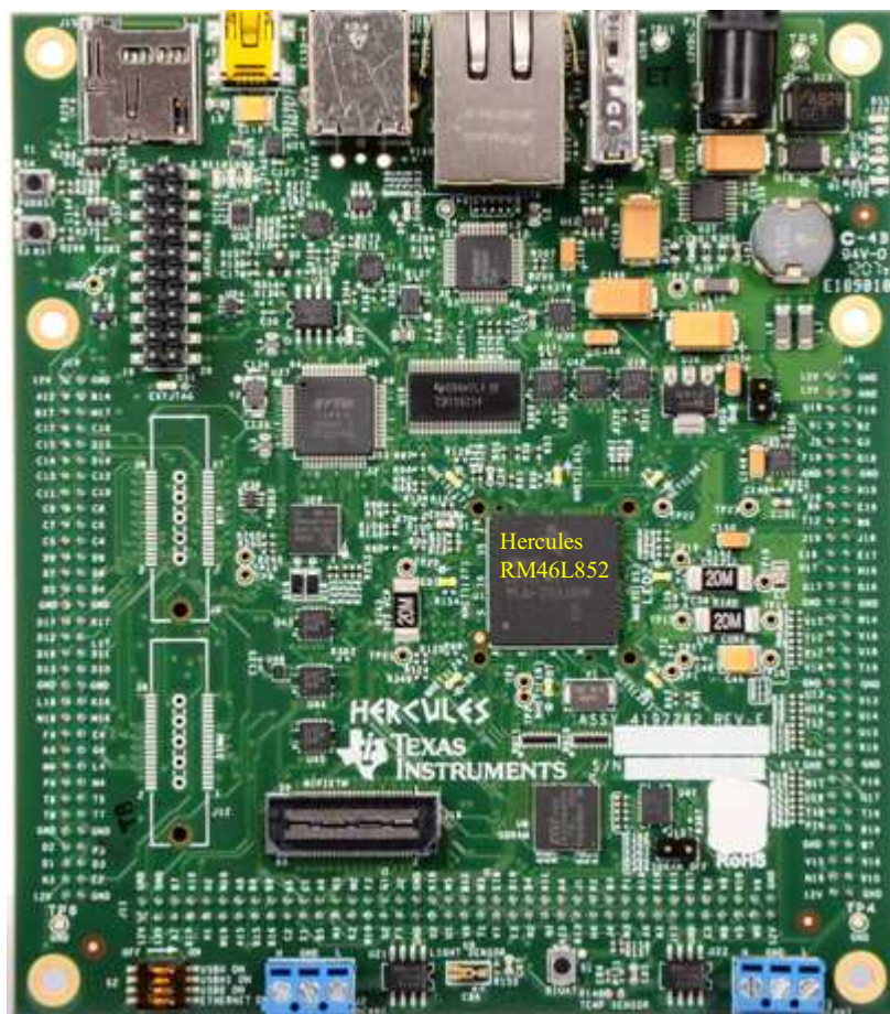
图 2-1. RM46HDK 电路板，接口顶部
